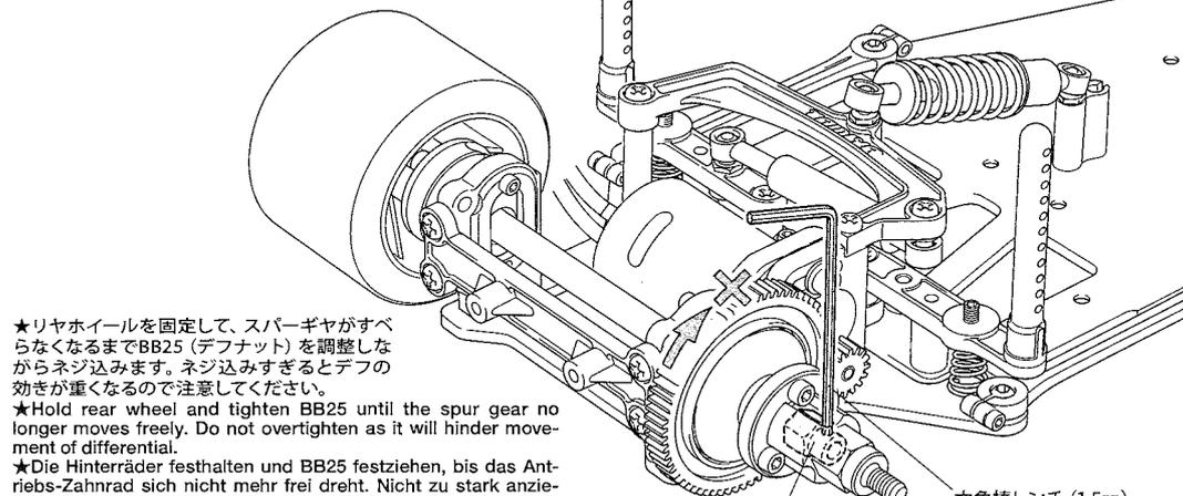
★リアホイールを固定して、スパーギヤがすべらなくなるまでBB25 (デフナット) を調整しながらネジ込みます。ネジ込みすぎるとデフの効きが重くなるので注意してください。
