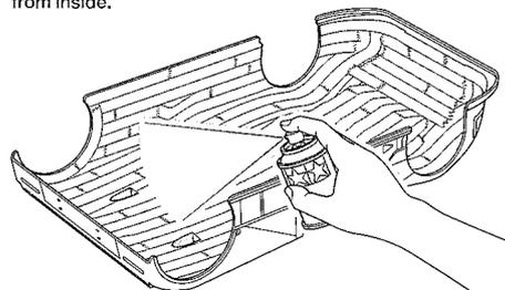
③ ★ボディを内側からPS-5(ブラック) で塗装します。スプレー塗装はボディから30cmほどはなし、一度に塗らず数回に分けて塗ります。
