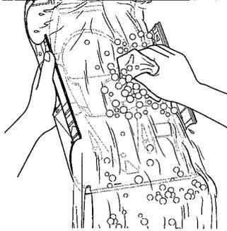
★塗装前に中性洗剤で油気をおとします。水洗いをして洗剤分を洗い流して乾かしてください。
